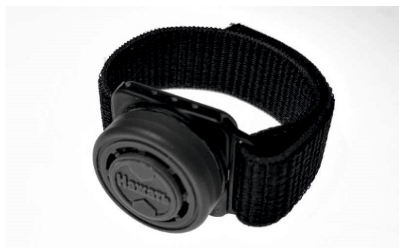
Прототип устройства для трансдермального введения лекарственных препаратов с помощью массива полых микроигл
