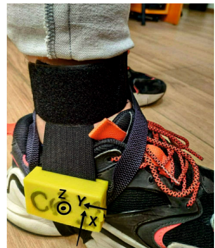
Расположение измерительного модуля на латеральной стороне правой лодыжки
