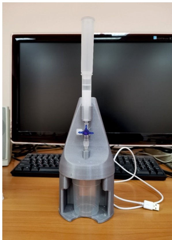
Хроматографический сенсор после установки колонны и буферного резервуара
