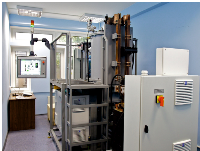
Автоматическая высокотемпературная вакуумная установка для выращивания слитков полупроводникового карбида кремния
