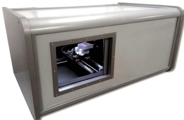
Рентгеновский компьютерный томограф для исследования кернов геологических пород «РКТ-Гео»
