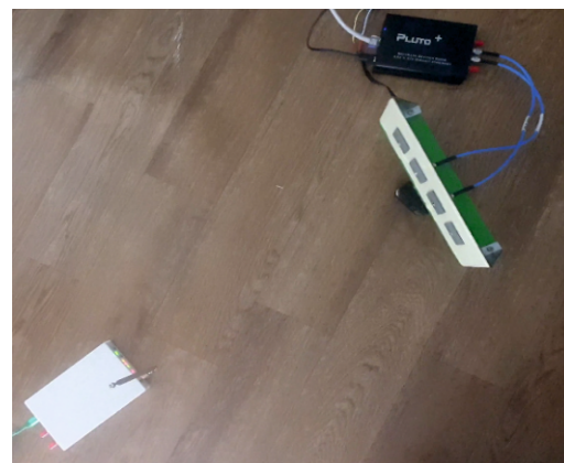
Антенный трекер на базе разработанной системы
