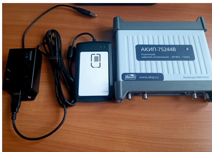
Программно-аппаратный комплекс для проверки SIM-карт на уязвимость к атакам по сторонним каналам: плата, картридер, осциллограф
