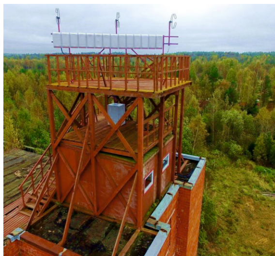
Пассивная когерентная радиолокационная система дистанционного контроля с использованием радиоизлучения сторонних источников
