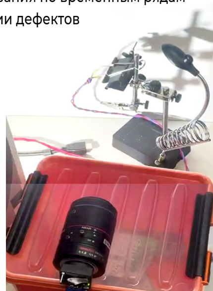
Внешний вид прототипа системы бесконтактного измерения и регистрации вибраций промышленного оборудования
