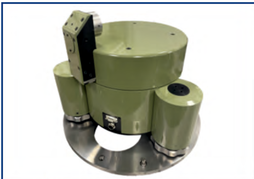
Автоматизированный угломер для стенда поверок роботизированных тахеометров
