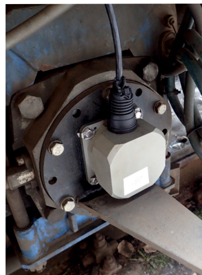
Инерциальный измерительный модуль для диагностики дефектов на поверхности катания рельсов
